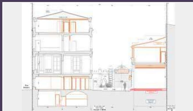
Coupe transversale de l'ensemble avec indication des démolitions prévues, CVP octobre 2022 (© Studio Vincent Eschaliér).
