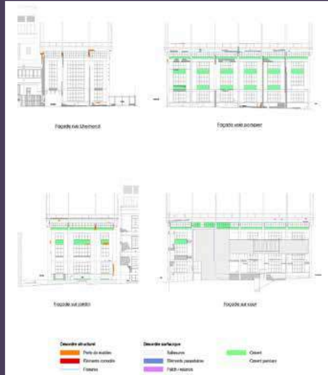
Etat sanitaire des façades - Faisabilité 2022 (© Antonini architectes associés).
