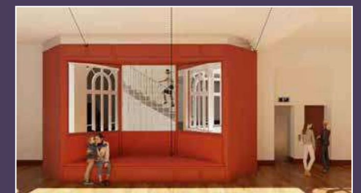
Cloison coupe-feu de l'escalier en forme de mobilier, 2022 (© Atelier KAPAA).
