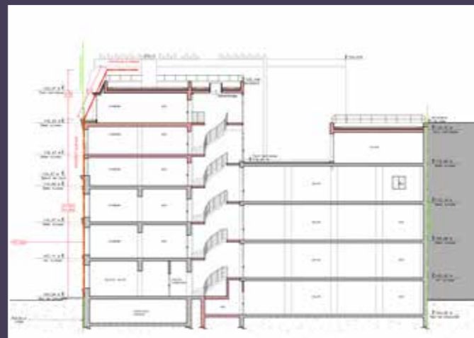
Coupe traversable de la parcelle avec la surélévation et les modifications projetées (© AR Architectes & JP Richard).
