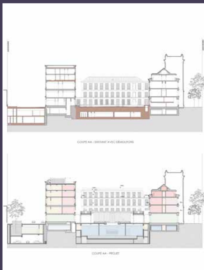
Coupe sur la cour de la bibliothèque, état actuel avec démolitions et état projeté (© COS architectes).
