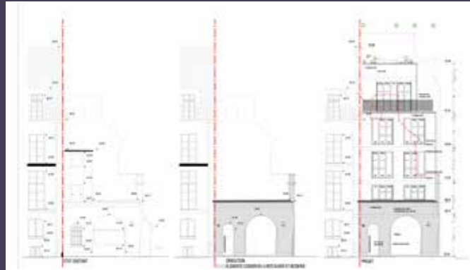
Rue Portefoin : état actuel, élévation avec les éléments préservés, état projeté (© ABDF architectes).
