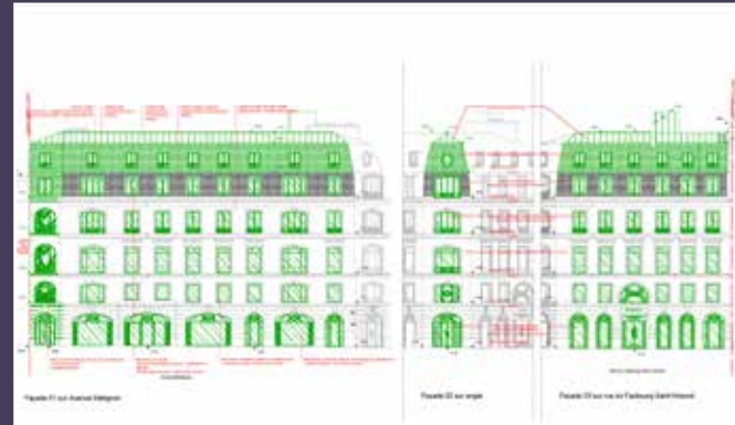
Développé des élévations, état projeté (© Architecture Studio).
