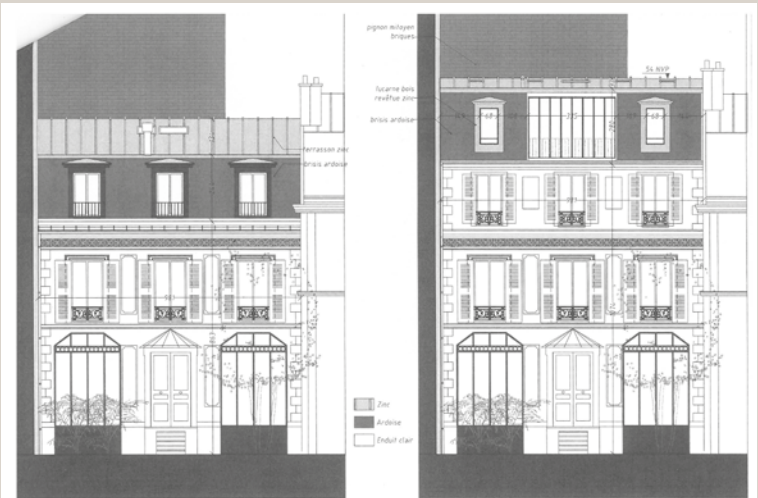
Élévations actuelle et projetée (© Akpa architectes).
