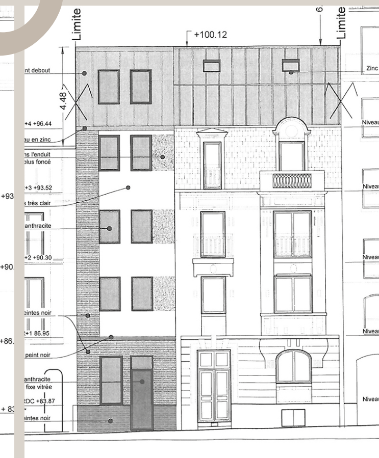
Élévations côté rue Belgrand : à gauche, l'état actuel, à droite, l'état projeté (documents Arcimboldo). L'état actuel correspond aux dispositions de 1936. Le projet prévoit la surélévation de l'extension de gauche et un nouveau dessin de sa façade ; la toiture de l'hôtel serait redressée d'un 3 e brisis.
