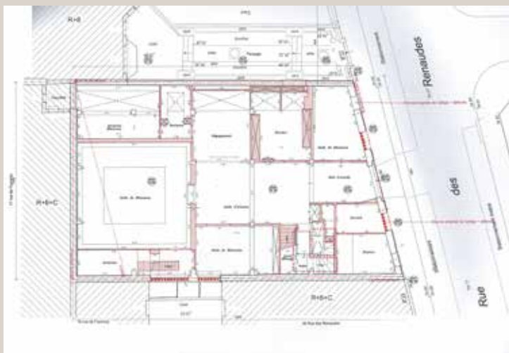
Plan de démolition du rez-de-chaussée (© DGM & Associés).
