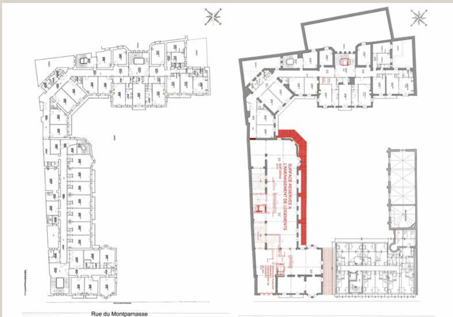
Plan du premier étage, états existant (à gauche) projeté (à droite) (© A-C. Perrot & F. Richard architectes).
