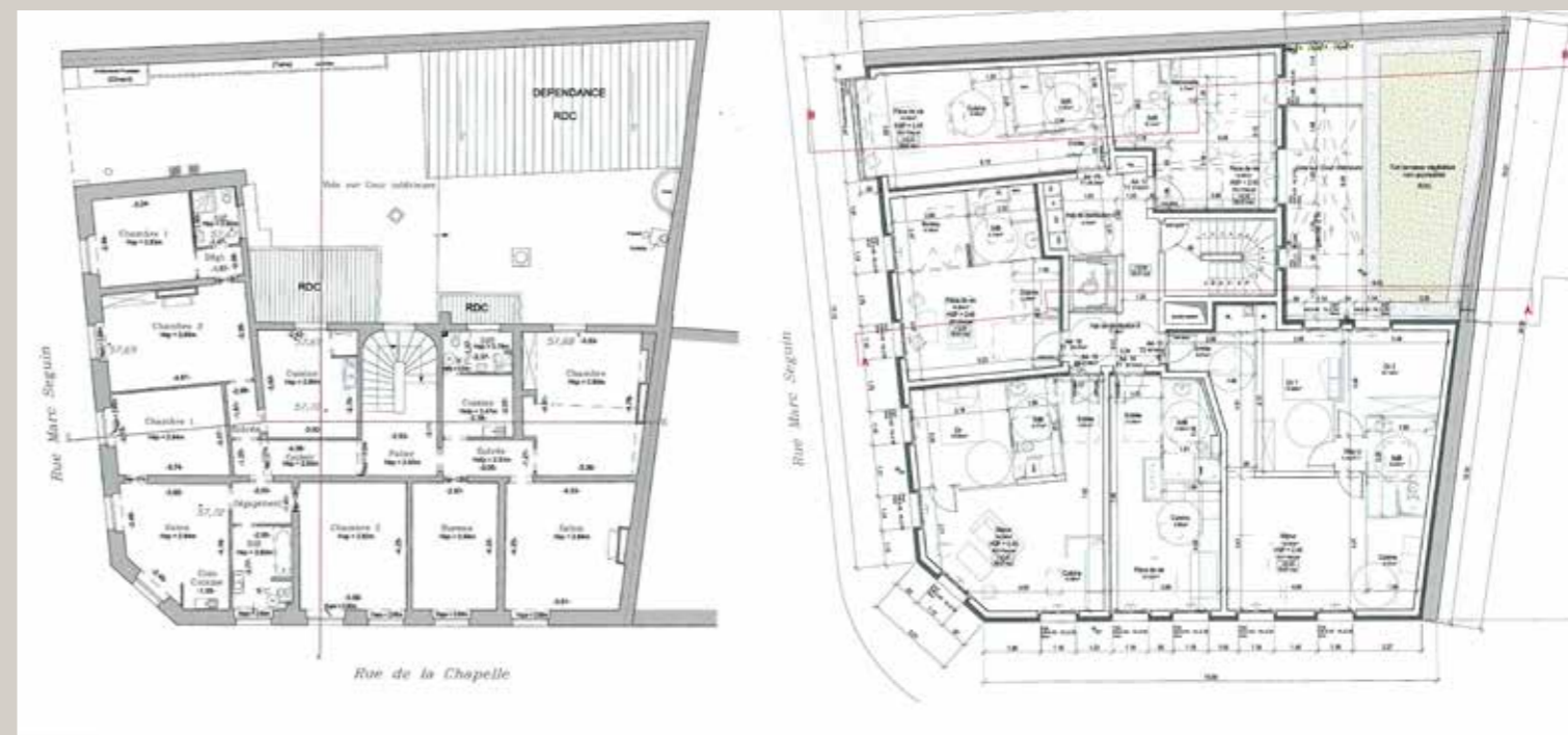
Plans d'un étage courant, état actuel à gauche et état projeté à droite (© ARTEFAKT).
