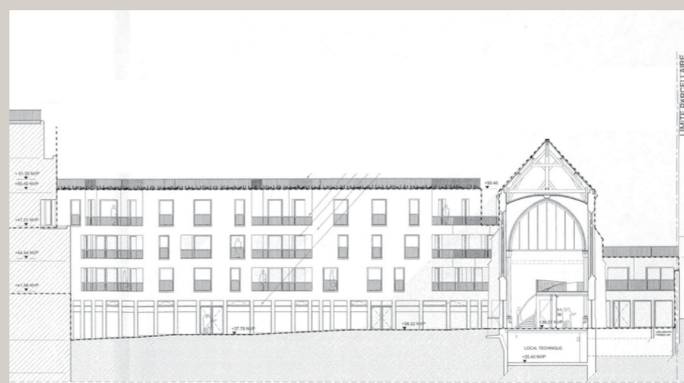
Coupe projetée sur le nouveau jardin et la chapelle restructurée (© h2o architectes).
